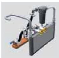
**Post-refrigeratore integrato con** separazione automatica della condensa: riduce il contenuto di acqua nell'aria compressa. Uno scambiatore di calore aggiuntivo utilizza l'olio del compressore per riscaldare l'aria compressa e proteggere gli attrezzi dal gelo.
