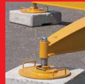
Il posizionamento della gru nel luogo stabilito è facile, poichè si può montare in tutte le direzioni. La maneggevolezza è garantita da particolari assali sterzanti che consentono minimi raggi di curvatura. La facilità con cui si possono rimuovere gli assali consente di poterli custodire in luoghi sicuri. Viti di regolazione permettono la perfetta messa in bolla della gru.
