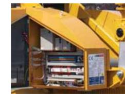
Al fine di consentire una maggior protezione ed un facile accesso, si è provveduto ad integrare il meccanismo di rotazione e la centralina idraulica di montaggio all'interno della base girevole.
